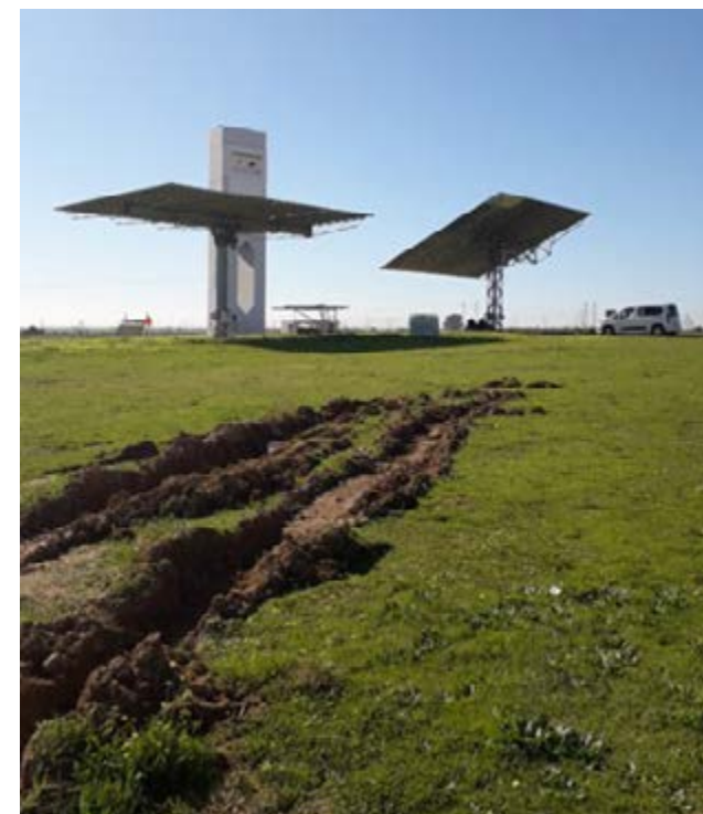
► Detalle de heliostatos en la plataforma de ensayo Pontones.
