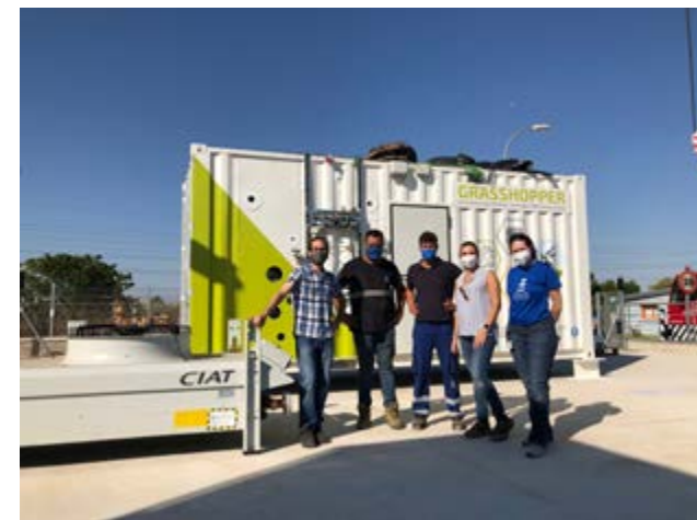
► Grasshopper, una nueva generación de plantas de potencia basadas en pilas de combustibles a partir de hidrógeno verde.
