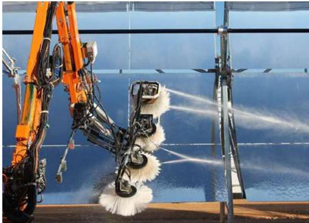
Vehículo de limpieza de colectores cilindroparabólicos.
