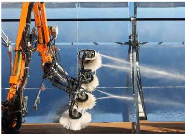
Vehículo de limpieza de colectores cilíndroparabólicos.
