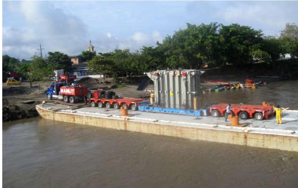
Transporte de transformadores de potencia para cogeneración de Pemex.
