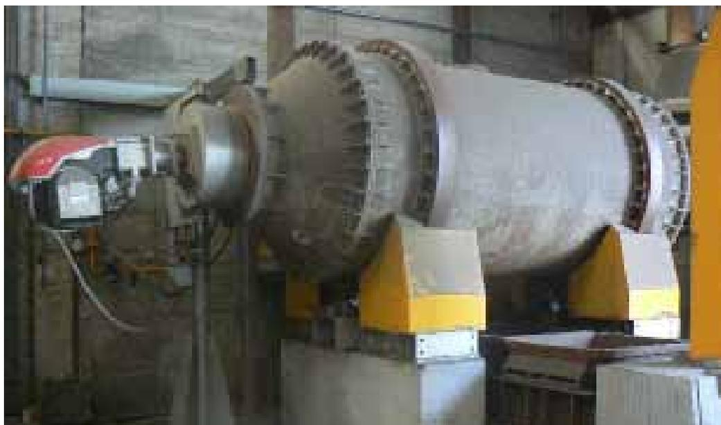
Horno rotativo de 1 t de capacidad que se instalará en Valladolid
